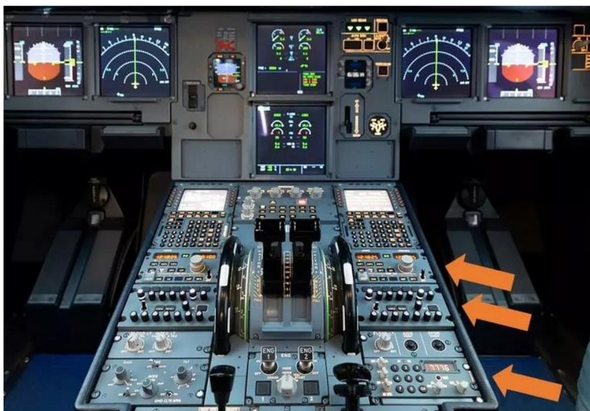
Illustration de la localisation du DRAIMS dans un avion Airbus une fois son montage réalisé (source : Airbus 55 )
